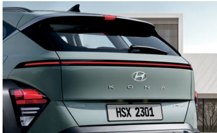
مصباح توقف عالي التثبيت مدمج بالجنح الخلفي، مصباح خلفي أفقي من دون وصلات مصباح مكابح LED، مصباح إشارة الانعطاف LED
